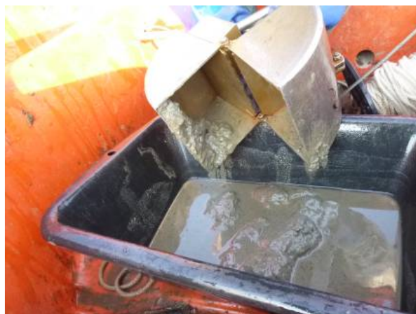
Prélèvement à la benne Van Veen
